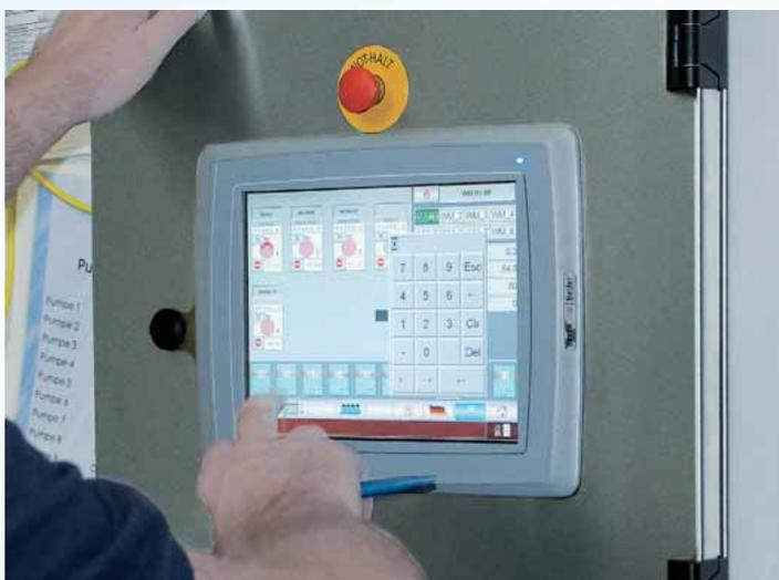
Steuerschrank für BÜFA 10 DOS 8-System und BÜFA 20 DOS 5-System
